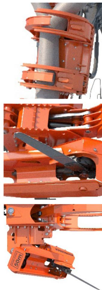
**5** La **fonction d'inclinaison** empêche le blocage de la tronçonneuse lors de la coupe.
