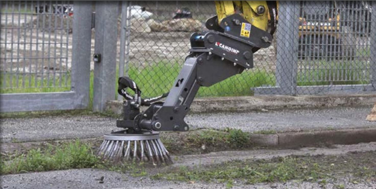
CETTE BROSE, POUR PELLETEUSE, DOTÉE D'ÉLÉMENTS EN ACIER, EST ADAPTÉE AU NETTOYAGE DE BORDURES, TROTTOIRS ET ACCOTEMENTS DES ROUES. LE SYSTÈME FLOTTANT ET LE JOINT, DE SÉRIE, PERMETTENT À LA BROSE DE SUIVRE LES SURFACES. LES DEUX SYSTÈMES D'ARTICULATION PEUVENT ÊTRE BLOQUÉS EN POSITION FIXE SELON LES EXIGENCES DE L'UTILISATEUR. EN ADOPTANT LA BROSE EN PPL ON PEUT TRAITER LES SURFACES LES PLUS DÉLICATES OÙ LE DÉSHERBAGE N'EST PAS NÉCESSAIRE.
