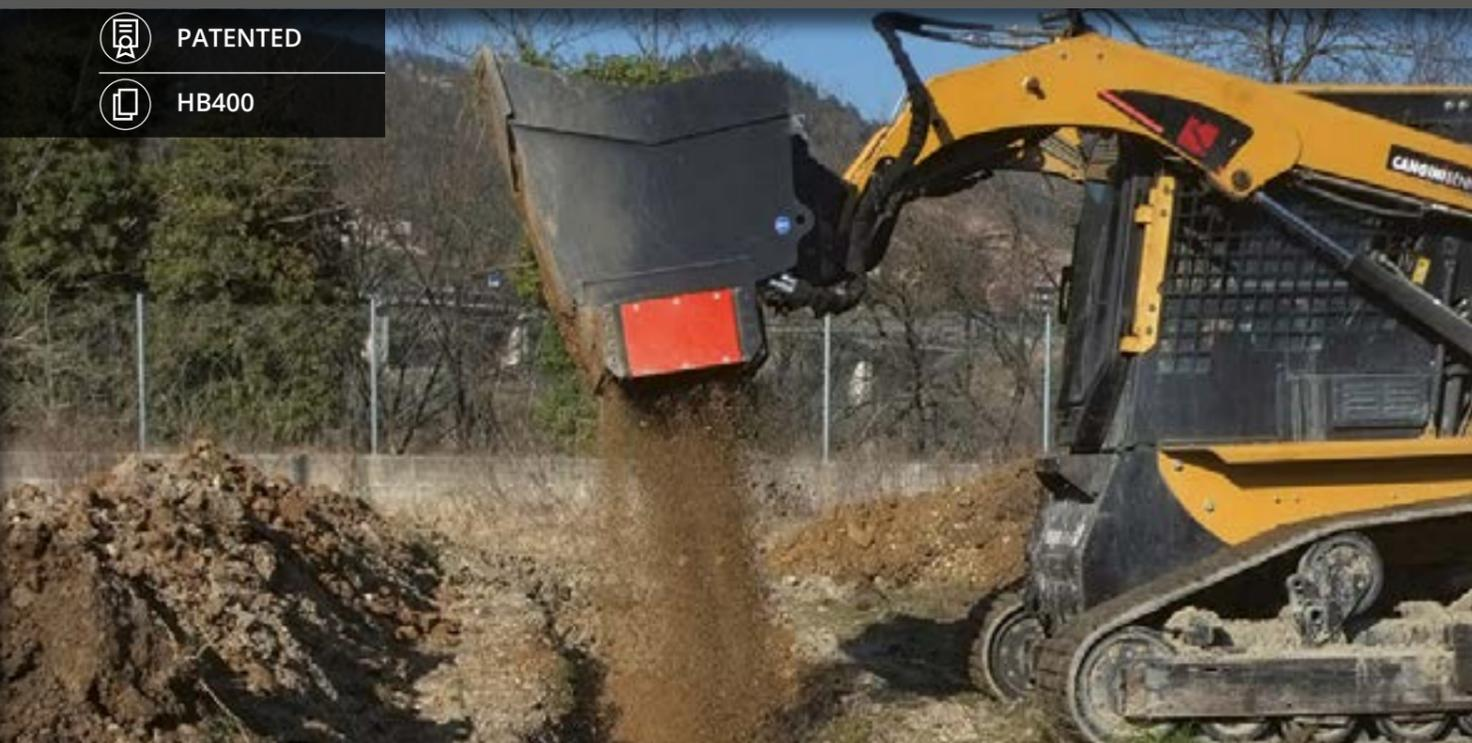
ADAPTÉ À LA SÉLECTION DE DÉCHETS DE TRAVAUX DE DÉMOLITION, CONCRASSAGE OU TERRASSEMENT, ET AU MALAXAGE DE TERRE ET TOURBE GRÂCE AU CRIBLEUR HYDRAULIQUE DOTÉ DE COUTEAUX ROTATIFS EN HB400. EN CONFIGURATION STANDARD, LA TAILLE DU MATÉRIAU PEUT ÊTRE COMPRISE ENTRE 0 ET 20 ET ENTRE 0 ET 35.
