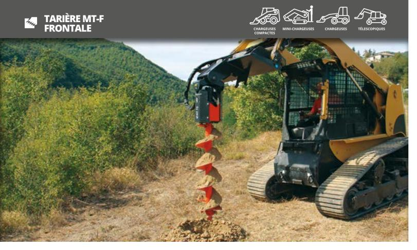
LA TARIÈRE HYDRAULIQUE BIDIRECTIONNELLE PEUT ÊTRE APPLIQUÉE SUR DES MINI CHARGEUSES, DES CHARGEUSES, DES PELLES ET DES CHARIOTS TÉLESCOPIQUES. ELLE EST DOTÉE DE TRANSMISSION AVEC RÉDUCTEUR ÉPICYCLOÏDAL ET DOUBLE JOINT. LE REDUCTEUR EST PROTÉGÉ DES CHOCS GRÂCE À UNE BOÎTE EN ACIER.
