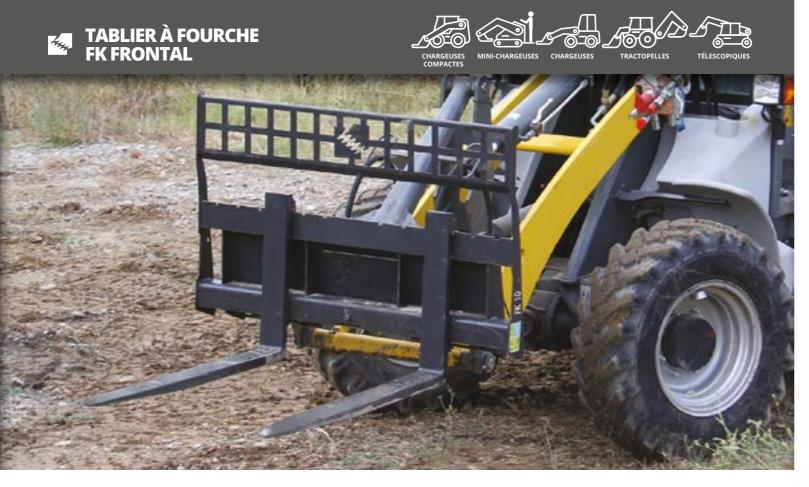
LE TABLIER FRONTAL PERMET L'ACCROCHAGE À CHARGEUSES COMPACTESS, CHARGEUSES SUR PNEUS, TÉLESCOPIQUES ET TRACTOPELLES. EQUIPÉ D'UNE PROTECTION DE SÉCURITÉ CONTRE LE RENVERSEMENT DES CHARGES PENDANT L'UTILISATION.
