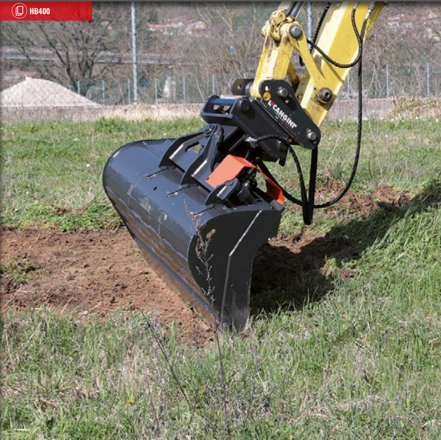
PARTICULIÈREMENT ADAPTÉ AUX TRAVAUX DE FINITION ET NIVELAGE. SON MOUVEMENT PERMET D'INCLINER LE GODET DE 45° SUR LES DEUX CÔTÉS. LA VANNE DE BLOCAGE DE SÉRIE PERMET DE TENIR L'INCLINAISON. SA FORME ALLONGÉE EMPÊCHE QUE LE TERRAIN ADHÈRE AUX PAROIS LATÉRALES DU GODET ET FACILITE LE DECHARGEMENT DES MATÉRIEAUX ARGILEUX ET MOUILLÉS. INDIQUÉ POUR L'ENTRETIEN ET LE NIVELAGE DE ROUTES, FOSSÉS ET TALUS. LAME EN HB400.
